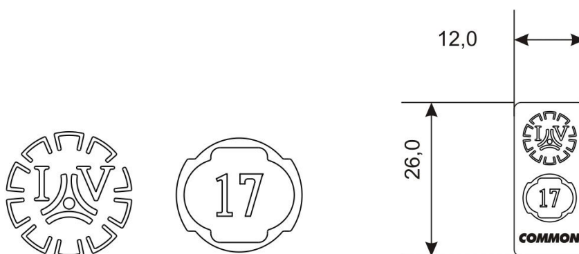
Rys. 12a. Cecha weryfikacji pierwotnej (liczba 17 – dwie ostatnie cyfry roku przeprowadzenia weryfikacji pierwotnej)
