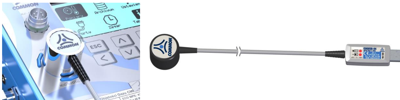
Rysunek 13.1 Umiejscowienie głowicy OPTO-GAZ na przeliczniku
