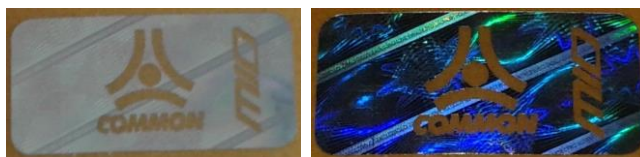
Rysunek 8.2 Widok poprawnej cechy metrologicznej
