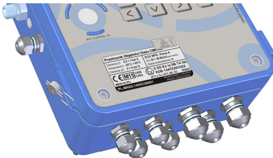
Rysunek 8.9 Umiejscowienie tabliczki „MID”
