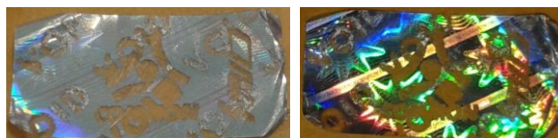
Rysunek 8.3 Widok uszkodzonej cechy metrologicznej
