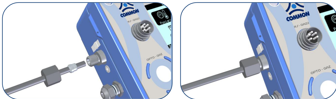
Rysunek 5.11 Podłączenie pomiaru ciśnienia od strony przelicznika
